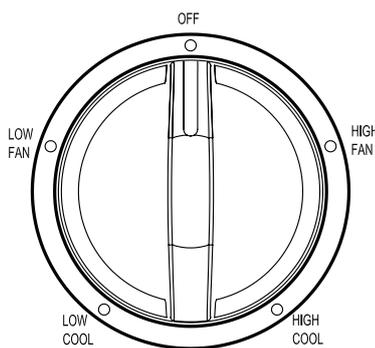
При помощи этой ручки Вы можете регулировать режим работы кондиционера. Данная модель имеет следующие режимы работы:
